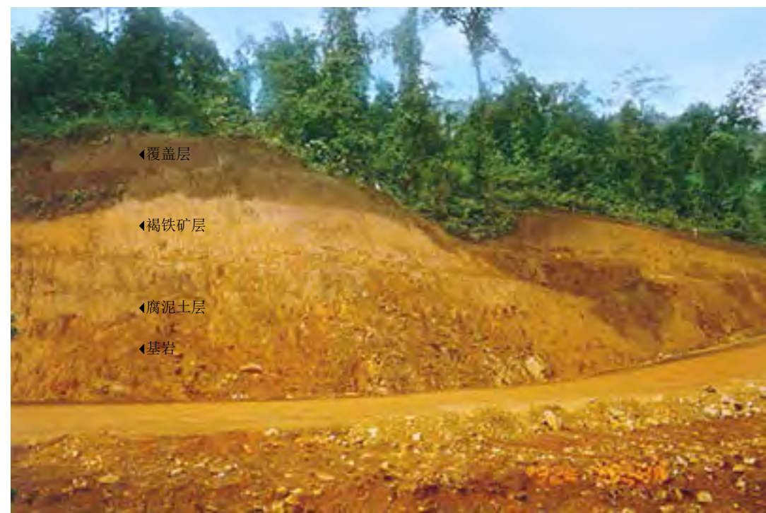
图8.7 - 苏拉威西镍矿区红土镍矿矿层概况
