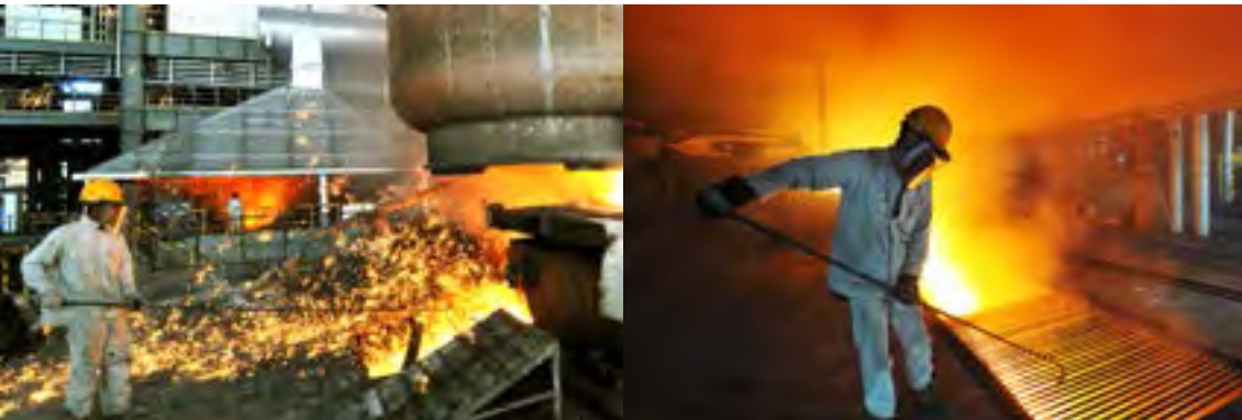
图4.2 - 工人在电炉旁（右）处理撇渣（左）和攻丝金属镍生铁。面罩和防毒面具用于保护工人免受因铁水造成伤害。
