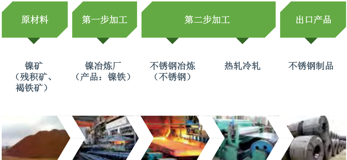
图8.1 - 将镍矿加工成不锈钢的各个阶段 数据来源：中国印尼综合产业园区青山园区，2016年。
